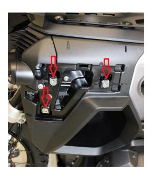
Anschraubpunkte des Aluminium Seitendeckels. Hier werden die Hornig Tankseitentaschen zusammen mit dem Alu-Seitendeckel verschraubt (3 Schrauben).
