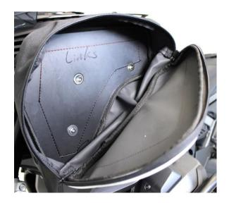
Foto vom Inneren der Tankseitentasche. Die je 3 großen Unterlegscheiben innen verwenden. Ist alles fest verschraubt, kann die Tasche schon benutzt werden.
