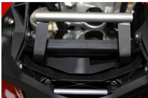
So sieht dann der montierte GPS-Halter von vorne gesehen am Motorrad aus.
