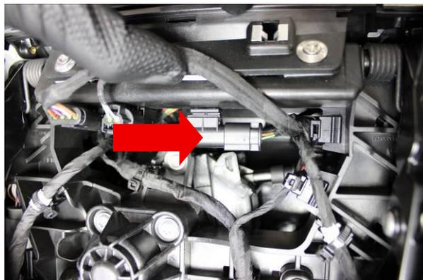
Entfernen Sie das Windschild und ziehen Sie die Frontabdeckung nach vorne ab, darunter befindet sich der 12V Anschluss für das GPS und die Gewinde für den Haltebügel.
