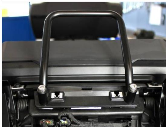
Für Zubehörgeräte verwenden Sie Kabel 0413585 am weißen Stecker. Montieren Sie den Haltebügel mit den mitgelieferten Schrauben.
