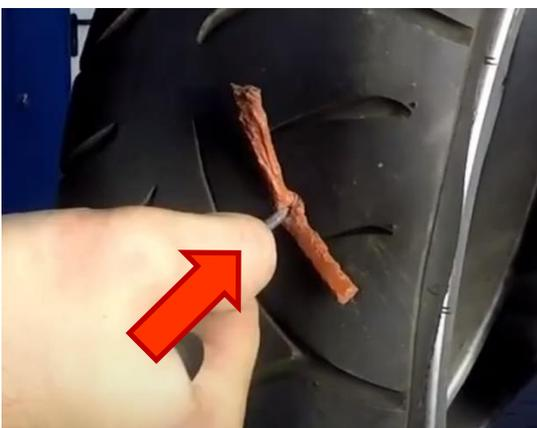
5. Drücken Sie den Streifen durch links, rechts drehen in das Loch. Wenn der Streifen im Loch ist, drehen Sie das Werkzeug um 360° und ziehen Sie es heraus.
